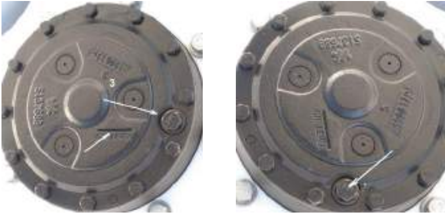
3 otvor za kontrolu i dolivanje, prednji bočni reduktor HEMA PODMAZIVANJA PREDNJEG MOSTA
